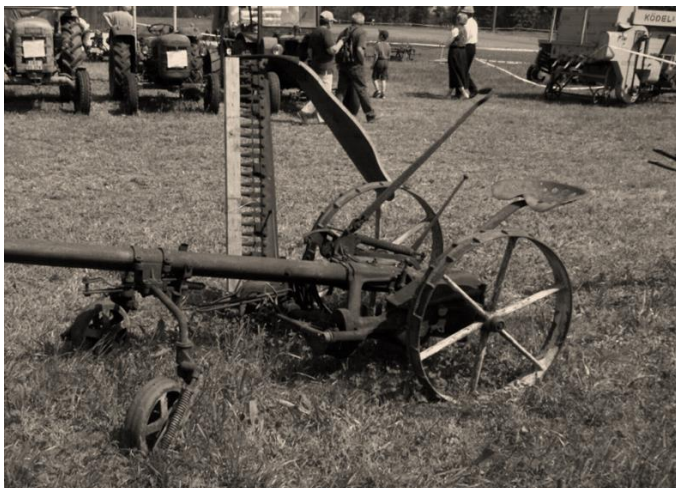
Abb. 2 Balkenmäher zum Zug mit zwei Pferden (gemeinfreie Abbildung)
